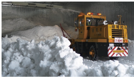
雪資源を活用した雪室を整備し、夏季の保冷に活用することでカスミソウの品質確保・向上を図っている。
