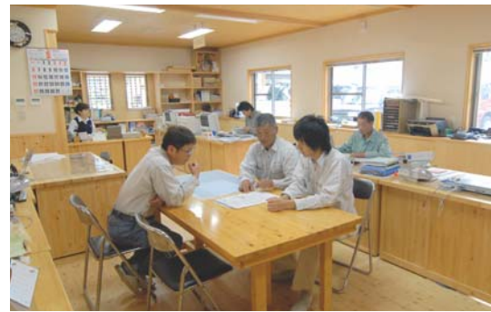
大正町森林組合事務所。壁・床からオフィスデスクまで集成材を使用
