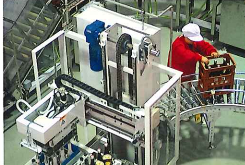
上から2階にある仕込みタンクと1階のプラント。長い時間をかけて熟成した酒は濾過、割水、殺菌して瓶詰めされる。機械化したため「ラクしているのかな」と女性社員はまだ戸惑っている
