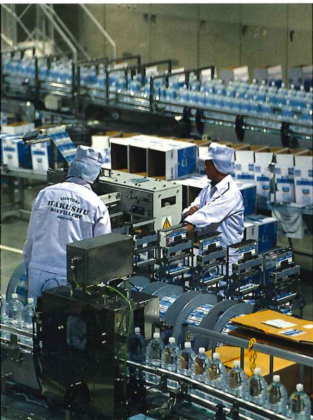
◀サントリーのミネラルウォーター工場 厳しく管理されたクリーンルームでボトリングが行われている
