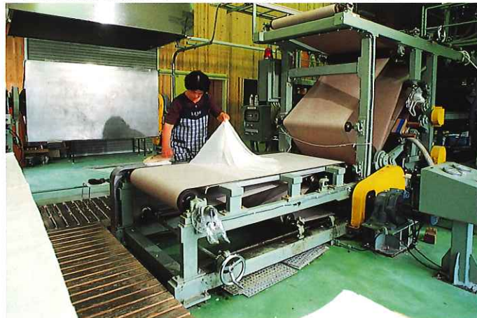
手すき和紙製造を機械化した自動省力化システム。下は乾燥作業。
