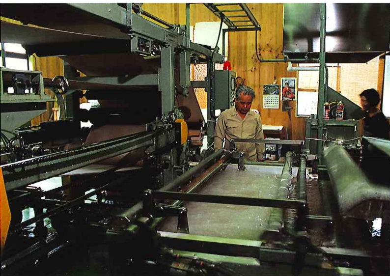
手すき和紙製造を機械化した自動省力化システム。下は乾燥作業。
