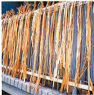
モワダの皮(シナノキ)は水に漬けて腐らせ、繊維だけを取り出す
