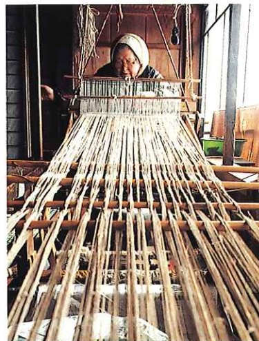
▲枠取り、よりかけのあと、やっつと機織りに入る。タテ糸は糊をつけて乾かし、ヨコ糸は糸車で竹管に巻き、水に浸して枠におさめて織っていく。
