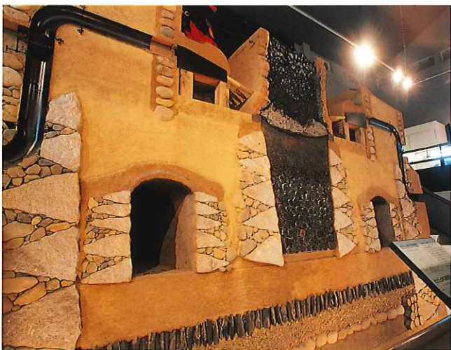
刀剣館にはたたら構造(地下4m)が原寸大の模型で展示してある。
