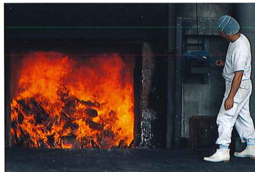
▲塩を煮詰めるのに薪を炊く。我が国最大級の平釜
