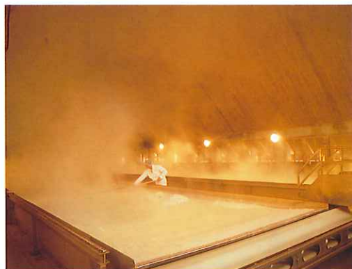
▲不純物を取り除いた濃い塩水は貯蔵タンクに
