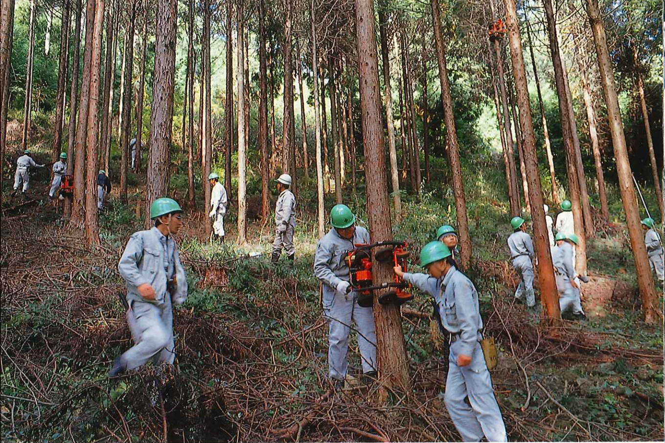
3班に分れて、ツリーモンキーを操作する。機械に強い若者らしく覚えは早い。
