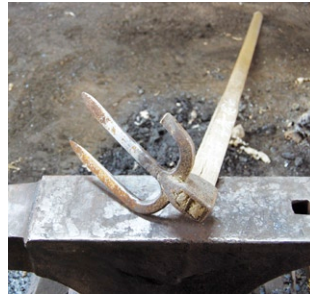
▲修理に持ち込まれた鋏 ▶先端に新たに鋼を加えて作り直した鋏
