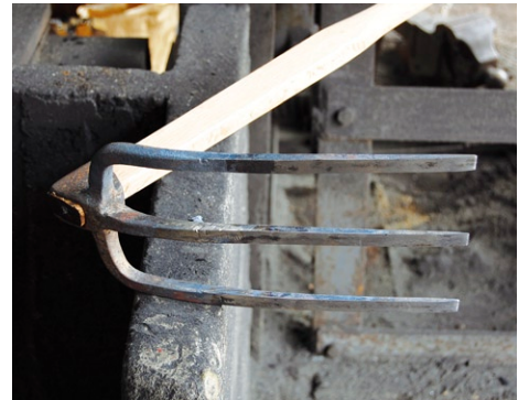
▲農耕用に使う鋏、修理前 ▶使い手の要望に合わせて作り直した鋏
