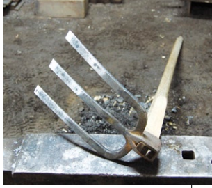
▲広島県安芸太田町／ 先端に銅を加えて修理した鋏
