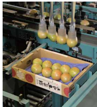
◀自動箱詰めをするロボットパライザー ▼機械が等級別に箱詰めしていく
