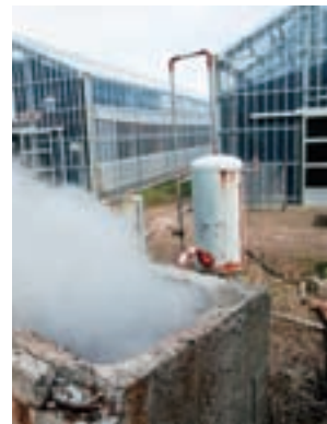
▼「スメ」と呼ばれる指宿市山川町鯉地区に伝わる地熱蒸気を利用した蒸し器
