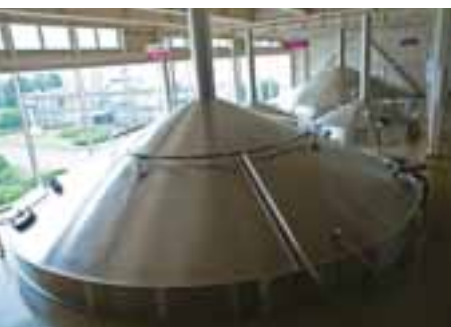
▲上/キリンビアパーク福岡の受付玄関 下/麦汁ろ過槽(手前)と麦汁受けタンク(奥側)が並ぶ、見学コースで見ることのできる工場内 ▲妹川政彦さん。工場内事務棟前、現在はシンボルとなっている旧型の糖化槽が後ろに見える
